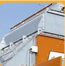
**2** Перфорированный низкопрофильный бункер для влажного продукта улучшает предварительный нагрев, позволяя нагретому потоку проходить сквозь наиболее влажное зерно.
