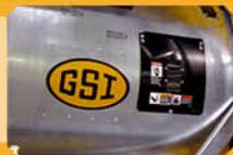
**14** Оцинкованный корпус вентилятора минимизирует окисление и коррозию, что увеличивает срок службы.
