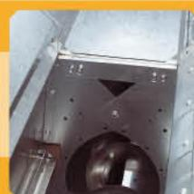
**17** Большие 38,1 см двери, упрощающие доступ к разгрузочному шнеку без использования специальных инструментов.
