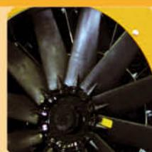
**13** Низкоскоростные, высокопроизводительные композитные лопасти вентилятора с частотой вращения 1725 оборотов в минуту перемещают воздух с меньшим шумом, чем высокоскоростные лопасти, используют меньшее количество энергии, чем радиальные вентиляторы, а их низкие стартовые нагрузки обеспечивают больший срок службы двигателя.
