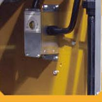
**10** Датчик давления воздуха проверяет давление воздуха в камере, подтверждая наличие воздушного потока.
