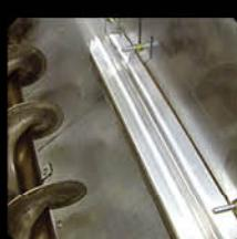
**РЕГУЛИРУЕМЫЕ ЗАСЛОНИКИ** позволяют контролировать объем зерна в каждой колонне, что дает улучшение качества и более равномерную сушку при низком качестве зерна и наличии большого количества мелких частиц.
