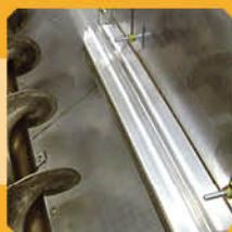
**20** Настраиваемые заслонки регулируют поток зерна, исключая "закупорку" колонн и обеспечивая ручную разгрузку колонн через нижний шнек.
