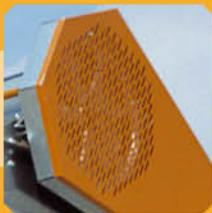
**3** Перфорированный кожух позволяет легко рассмотреть приводной шкив шнека и убедиться в его работоспособности.
