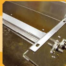
**21** Полностью алюминиевые дозирующие ролики, работающие в режиме обрачивания, гарантируют равномерный, аккуратный поток зерна при низкой мощности.
