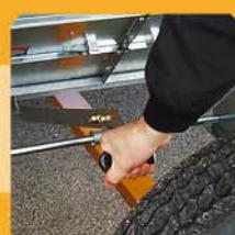
**19** Рукожатка, вынесенная за пределы сушилки, делает процесс открывания дверей для очистки шнека более быстрым и простым.
