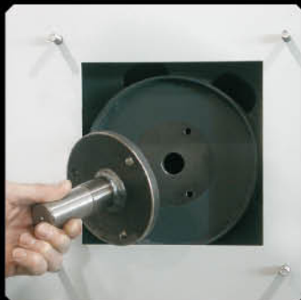
Для замены втулок на барабане предусмотрена точка доступа на обоих сторонах натяжной секции
